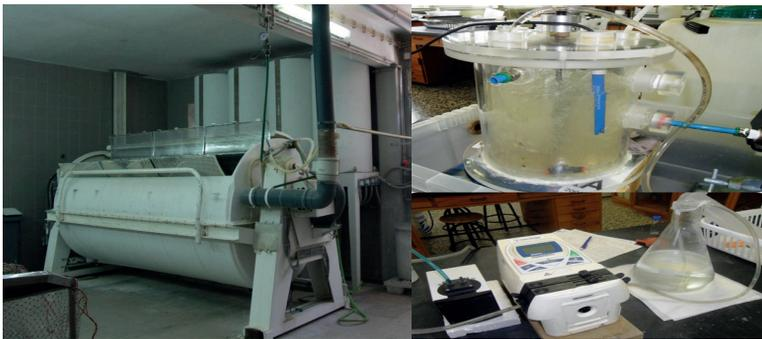
*Figura 8. Unidade industrial de lavagem de rolhas de cortiça (à esquerda). Unidade à escala laboratorial de tratamento do efluente da lavagem da indústria corticeira (à direita).*
