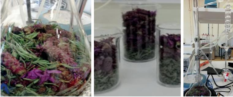
Figura 1. Preparação de material vegetal e hidrodestilação em aparelho Clevenger.
