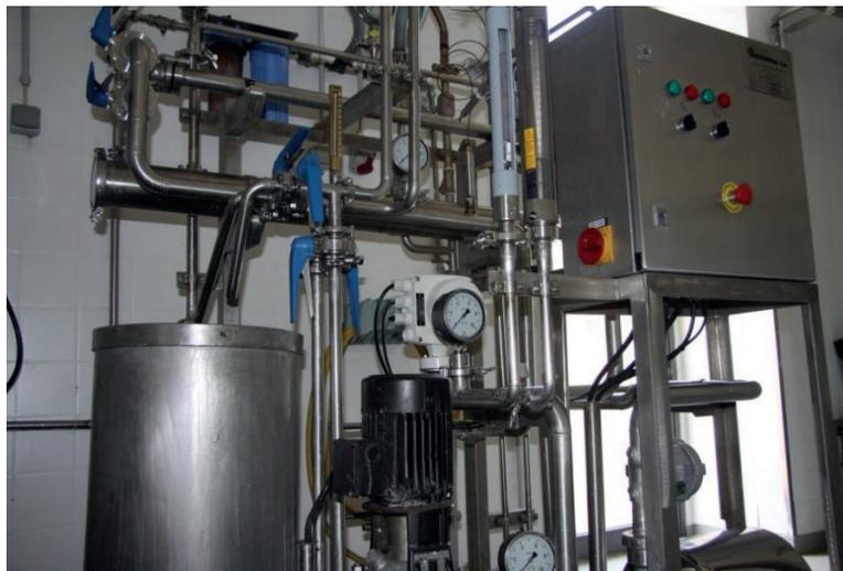
*Figura 3. Unidade piloto de microfiltração/ultrafiltração (MF/UF) utilizada em ensaios de valorização de resíduos das indústrias cárnea, cervejeira e do pescado.*
