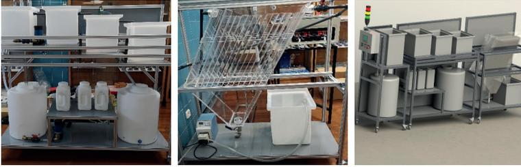
Figura 11. Aspeto geral do piloto para tratamento do efluente de lavagem da cortiça (à esquerda e ao centro). Esquema da unidade piloto (à direita).
