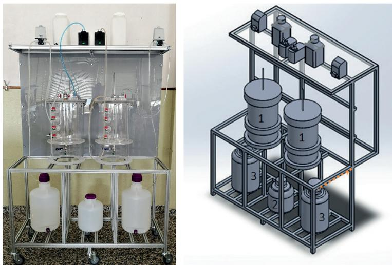
Figura 10. Aspeto geral do piloto para valorização de efluentes da indústria papelreira (à esquerda). Esquema da unidade piloto (à direita).
