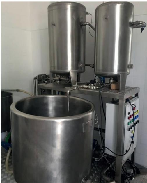
*Figura 4. Piloto de produção de requeijão com recuperação de energia construído no âmbito do projeto.*
