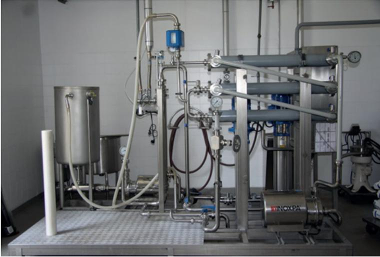
*Figura 2. Unidade piloto de microfiltração/ultrafiltração/nanofiltração/ osmose inversa (MF/UF/NF/OI) instalada no IPC/ESAC.*
