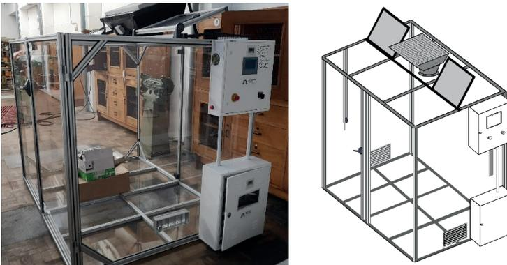
Figura 12. Aspeto geral do piloto para secagem de cortiça com apoio solar (à esquerda). Esquema da unidade piloto (à direita).
