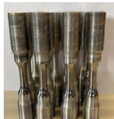
Provetes da liga de alumínio AlMg10Si fabricados por SLM.
