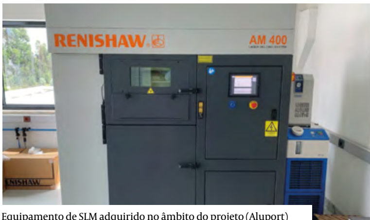
Equipamento de SLM adquirido no âmbito do projeto (Aluport)
